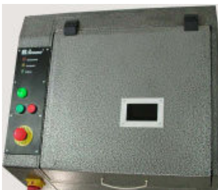
Фиг. 5.1.б) Контролен пулт на ProCast 50AL .
