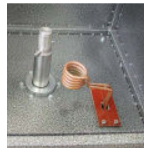
индукторът в горна позиция преди монтиране рамото на центрофугата
