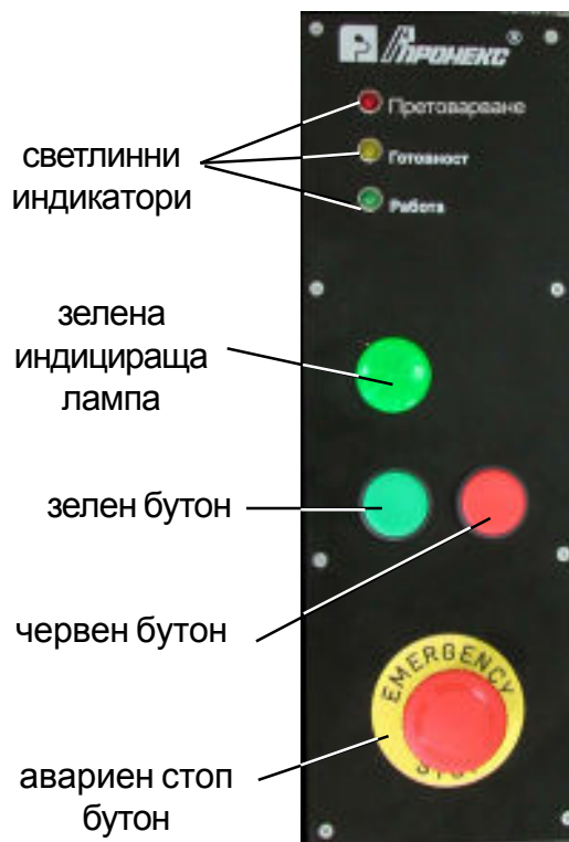
Фиг. 5.1.а) Контролен пулт на ProCast 50AL .
