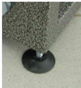
Фиг.4.8. Нивелиране на AproCast 50AL .
