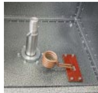
индукторът в долна позиция преди монтиране рамото на центрофугата
